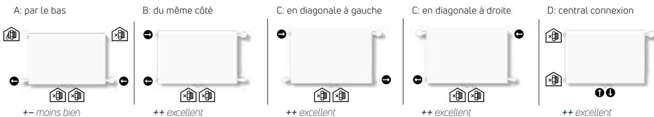
Le radiateur peut-être raccordé comme un radiateur compact en enlevant le corps de vanne thermostatisable.
