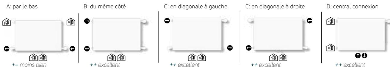
Le radiateur peut-être raccordé comme un radiateur compact en enlevant le corps de vanne thermostatisable.
