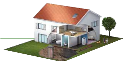
Captage sur sonde géothermique
