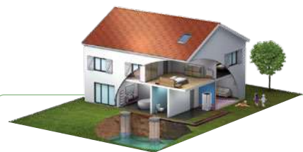
Captage eau de nappe
