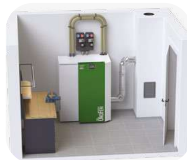
Stockage en mini silo
