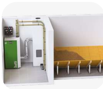
Stockage en pièce de réserve
