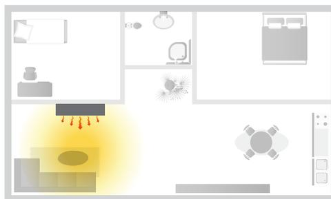
L'Ecopalex® GTM, en version standard, chauffe uniformément la pièce où il est installé grâce au mix de deux principes de chauffage : rayonnement et convection naturelle.
