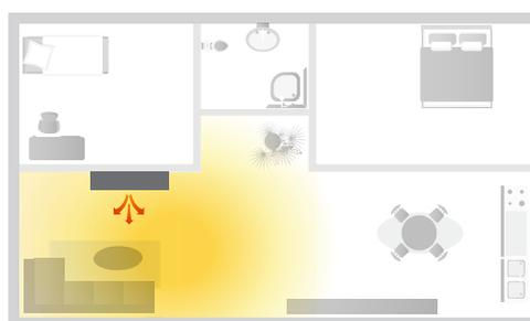
L'Ecopalex® GTM peut être équipé d'un ventilateur tangential, à l'intérieur de l'encombrement du foyer, afin de chauffer plus rapidement la pièce où il est installé.
