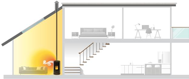
Les poêles Ecofire® à air ventilé sont dotés d'un ventilateur qui achemine rapidement l'air chaud produit par la combustion dans toute la pièce. Grâce à l'unité de contrôle, il est possible de gérer la puissance du poêle et la vitesse du ventilateur en fonction des besoins de chaleur personnels.
