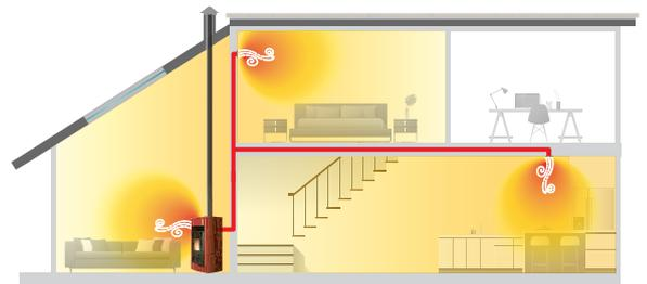
La technologie Palazzetti pour canaliser l'air chaud dans plusieurs pièces (jusqu'à 28 mètres de canalisation avec deux conduits de 8 cm de diamètre, pour une longueur maximale de 14 mètres par conduit). Ces conduits sont totalement indépendants l'un de l'autre afin de pouvoir gérer la température dans les différentes pièces de l'habitation de façon différente.
