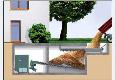
*Silo de stockage à la cave avec vis de transfert pour le remplissage par le soupirail*
