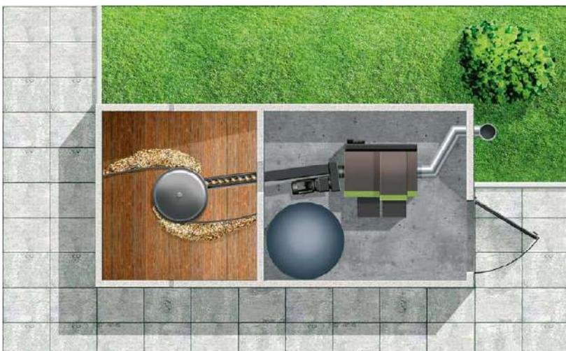
La chaufferie prémontée représente une solution de chauffage particulièrement flexible lorsqu'aucun espace n'est disponible pour créer une chaufferie dans le bâtiment à chauffer. Grâce à la structure modulaire de la chaufferie prémontée, il est possible de réaliser des installations de chauffage jusqu'à 400 kW. Une brochure d'information spécifique présente les solutions de chaufferie modulaires HDG.
